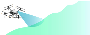
Когато работи при промени във височината радарът се фокусира върху склоновете отдолу
