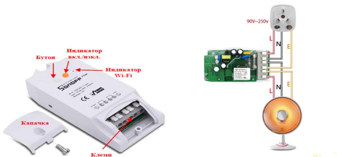
Фигура 3. Външен вид и електрическа схема на Sonoff Pow[2]
