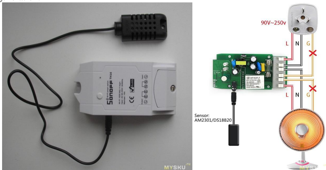
Фигура 1. Външен вид и електрическа схема на Sonoff TH 16 [2]
