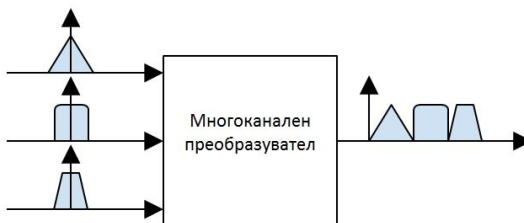
Фиг. 6. Принцип на действие на многоканален преобразувател.
