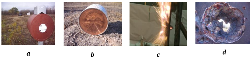
Фигура 1. Етапи на експлозивно формиране на ядрото и ударното взаимодействие с целта
